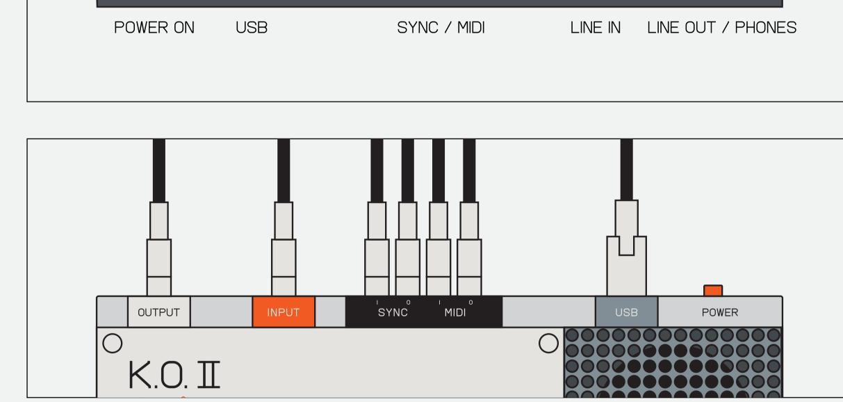
ON THE TOP SIDE OF THE UNIT, YOU WILL FIND ALL THE INPUTS AND OUTPUTS.
