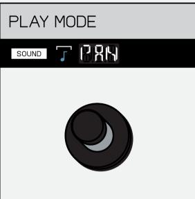
THE KNOB CONTROLS PAN. PAN GRADUALLY ADJUSTS WHETHER THE SAMPLE IS PLAYED ON THE LEFT, RIGHT OR CENTER AUDIO CHANNELS.
